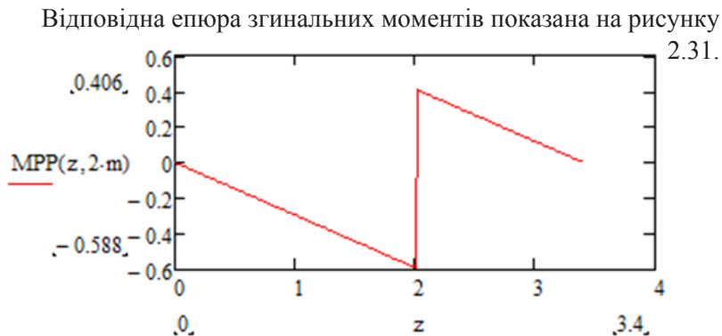
Рисунок 2.31 – Відповідна еюра згинальних моментів при навантаженні балки одиничним моментом у точці K
