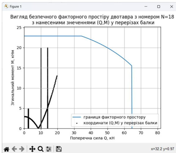
Рисунок В.30 – Безпечний факторний простір визначеного двотавра 18
