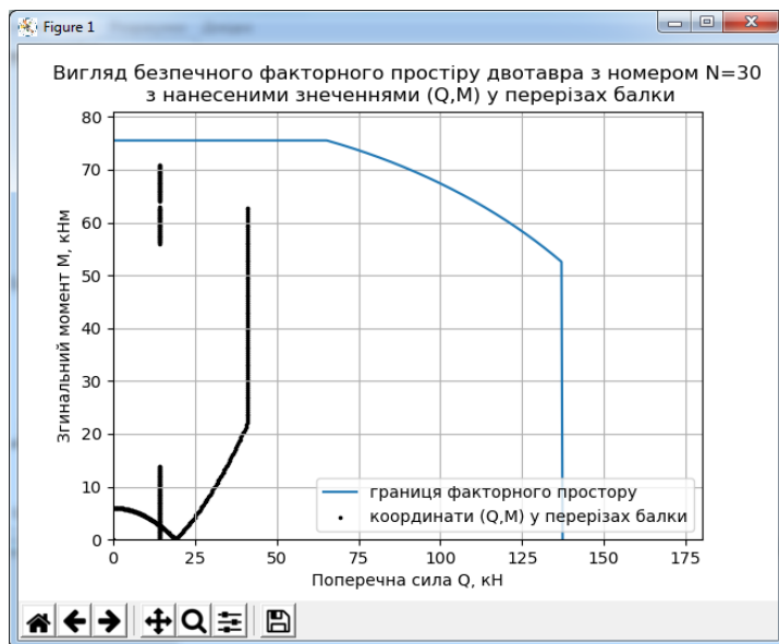
Рисунок 3.14 – Вигляд безпечного факторного простору профілю
